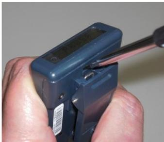
溝に沿ってマイナスドライバーを静かに押し上げながら、クリップを下に引き下げる
